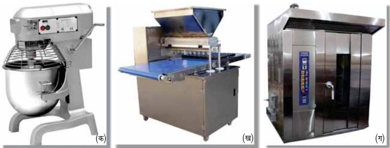
चित्र 7: श्री अन्न आधारित बेकरी उत्पादों को बनाने के लिए आवश्यक मशीनें (क) आटा मिक्सर (ख) कप आटा इंजेक्टर/आकार बनाने की मशीन (ग) रोटरी ओवन
