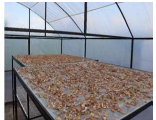
चित्र 3: अधिक वर्षा वाले क्षेत्रों के लिए उपयुक्त स्वचालित सौर सुरंग आधारित सुखाने की प्रणाली
