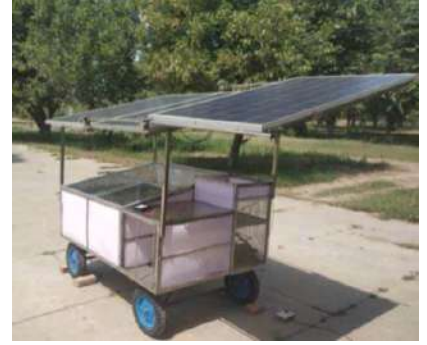
चित्र 5: सौर ऊर्जा चालित पीसीएम आधारित फल-सब्जी विक्रय ठेला प्रणाली
